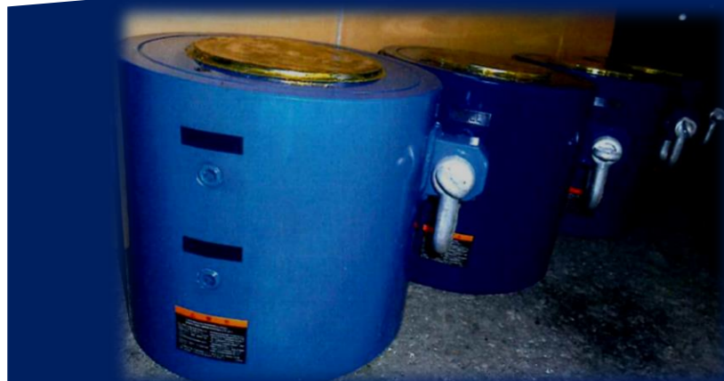
ジャッキ4台同調 異荷重対応
